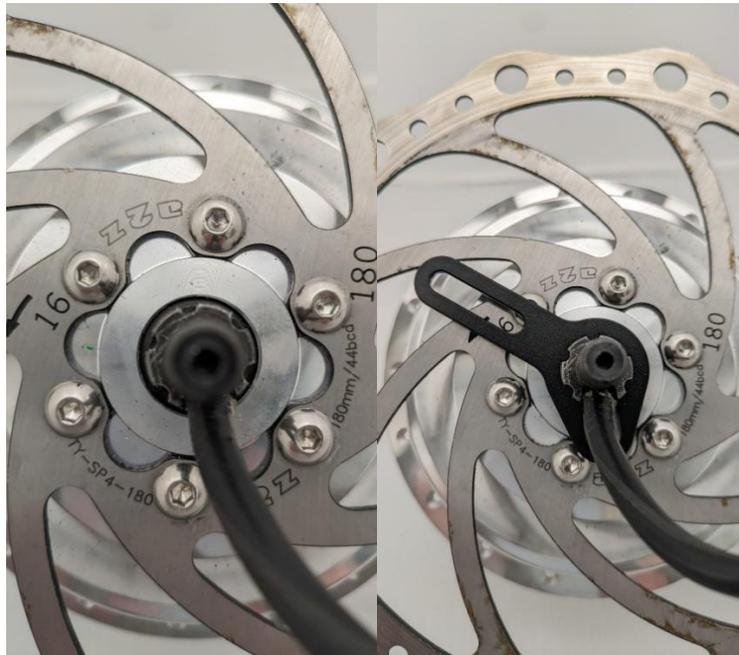
Die Hammerkopfschraube kann vor der Montage des Motors in den Längsschlitz der Drehmomentstütze von innen nach außen (dabei temporäre Fixierung mit der Mutter hilfreich) oder nach der Montage des Motors durch die Aussparungen in der Bremsscheibe eingeführt werden. Der Motor ist so in die Ausfallende der Vorderradgabel einzuschieben, dass das Motorkabel unten mittig aus dem Ausfallende austritt:
