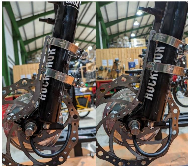
Bevor die Drehmomentstütze endgültig durch die Schlauchschellen an der Vorderradgabel fixiert wird, ist noch das Gummiprofil für die Ummantelung auf die Schlauchschellen aufzuschieben und passend abzulängen:
