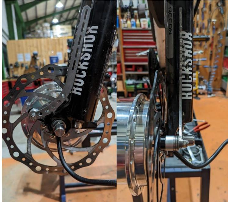
Nun ist die optimale Positionierung der beiden Schlauchschellen zu finden. Dabei sollte die obere Schlauchschelle möglichst oben installiert werden. Stehen die Positionen der Schlauchschellen fest, schneide den beigelegten Kantenschutz mit einem Seitenschneider passend zu und schiebe die Kantenschutzstücke auf die Drehmomentstütze auf:
