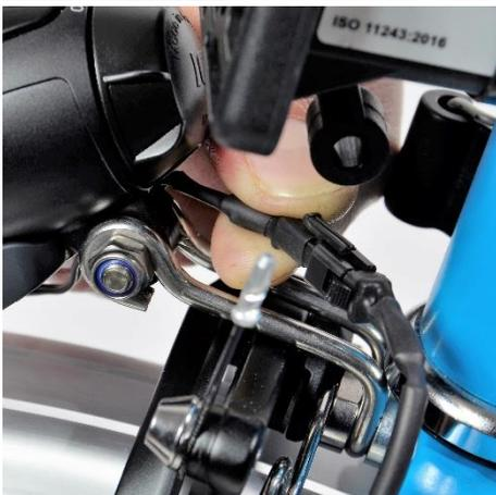
War bislang an Ihrem Brompton kein Rücklicht montiert bzw. ist keine elektrische Leitung zum Rücklicht vorhanden, müssten Sie jetzt ein entsprechendes Kabel vom Scheinwerfer bis nach hinten zum Rücklicht legen. Dieses weitere zusätzliche zweiadrige Kabel ist allerdings im täglichen Betrieb insbesondere beim Fold- und Klappvorgang eher störend und auch optisch durchaus fragwürdig.
