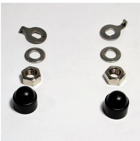
Zur Übertragung des Antriebsdrehmoments befindet sich auf der rechten Achsseite ein Mitnehmerzapfen, die sogenannte Verdrehsicherung, oft auch als Drehmomentnase bezeichnet:
