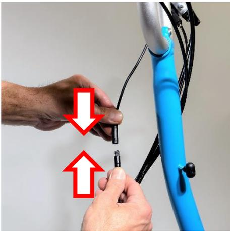
**Tipp:** Sollte das resultierende Kabel aufgrund eines hohen Lenkers in Verbindung mit einer langen Lenksäule zu sehr auf Zug belastet werden, können Sie unter der EBS Art.-Nr.: aelcdky-04 ein Display mit einem um etwa 8 cm verlängerten Anschlusskabel bestellen. Das dann ggfs. überschüssige Kabel verlegen Sie später in Schlaufen.
