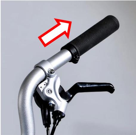
**Tipp:** Sofern der Lenkergriff nicht verschraubt und nicht mit dem Lenker verklebt ist, spritzen Sie zur Demontage des Lenkergriffs mit einer handelsüblichen Einwegspritze mit Kanüle ein wenig Wasser zwischen Lenkergriff und Lenker. Kurz einwirken lassen, danach den Lenkergriff abziehen:
